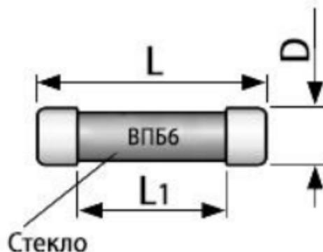
Габаритные и установочные размеры вставки плавкой ВПБ6.
