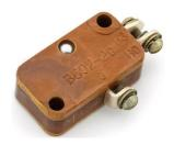
Микровыключатели B602-2C одноцепевые переключающие мгновенного действия без фиксации в нажатом положении. Предназначены для коммутации для коммутации электрических цепей постоянного тока при напряжении не более 30 В и силе тока до 2,5 А. Используются для работы в качестве микровыключателей в системах управления и сигнализации электронной аппаратуры специального назначения. Конструкция контактных выводов обеспечивает подсоединение монтажных проводов при помощи винтов.
