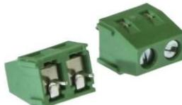
Винтовой модульный клеммный блок RUICHI RG127-5.08-02P, на плату, 2 контакта, шаг 5.00 мм - разновидность разъемного соединения проводов к печатным платам. Представляет собой группу винтовых или пружинных зажимов, собранную на пластиковом основании и снабженную контактами для пайки на печатную плату. Служит удобным и организованным способом выполнения электрических соединений, будь то распределение электроэнергии, маршрутизация сигналов или проводка управления.
