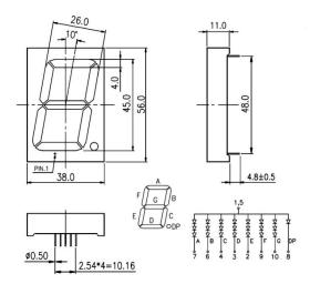
KEM-18102BR (Red) 45мм 50мКд Индикатор цифровой красный - это прибор для отображения значения числовой величины в цифровом виде. Индикаторы имеют семь сегментов и децимальную точку, излучающие свет при подаче прямого тока. Различные комбинации элементов, обеспечиваемые внешней коммутацией, позволяют воспроизвести любую цифру от 0 до 9.
