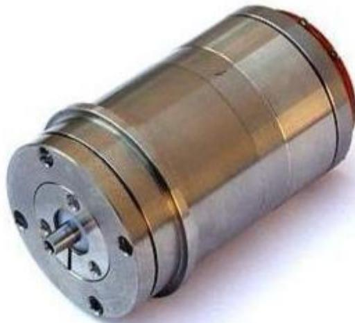
Бесконтактные вращающиеся трансформаторы 5БВТ предназначены для работы в электромеханических счетно-решающих устройствах, следящих системах, а также в качестве первичного датчика угла в цифровых преобразователях «Угол-Код». Съем сигнала в 5БВТ осуществляется с помощью кольцевых трансформаторов, что обеспечивает высокую надежность изделий.
