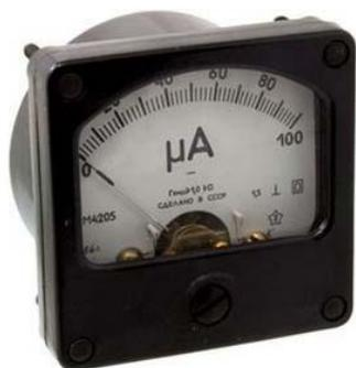
Микроамперметр М4205 предназначен для измерения тока в цепях постоянного тока. Приборы конструктивно оформлены в черных пластмассовых корпусах. Измерительный механизм - магнитоэлектрической системы, имеет внутрирамочный магнит, крепление подвижной части на растяжках, механический указатель стрелочный.
