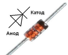
Диод **1n4148** обладает следующими отличительными свойствами:
