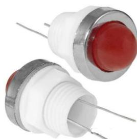
Лампочка неоновая в корпусе RUICHI N-318-R, 220 В, красная - это газоразрядная лампа, состоит из баллона, заполненного разреженным инертным газом (неоном), и укрепленных внутри баллона двух дисковых или цилиндрических электродов.
