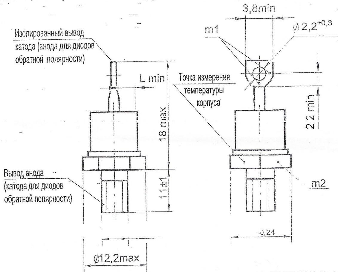
$m_1, m_2$  – контрольные точки измерения импульсного прямого напряжения,
