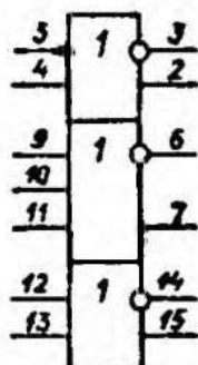
Условное графическое обозначение К100ЛМ105
