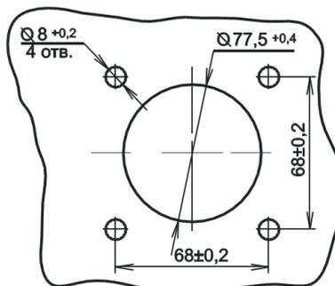
Рисунок 1 – Габаритный чертеж фазоуказателя
