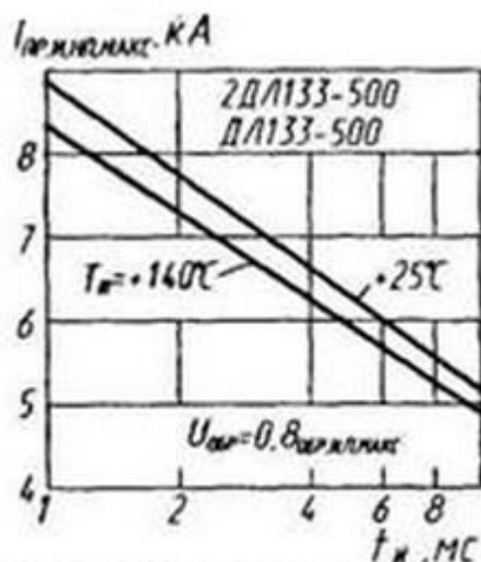
Зависимости допустимого неповторяющегося импульсного прямого тока от длительности импульса
